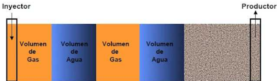
Figura 2. Esquema de inyección WAG [1]
